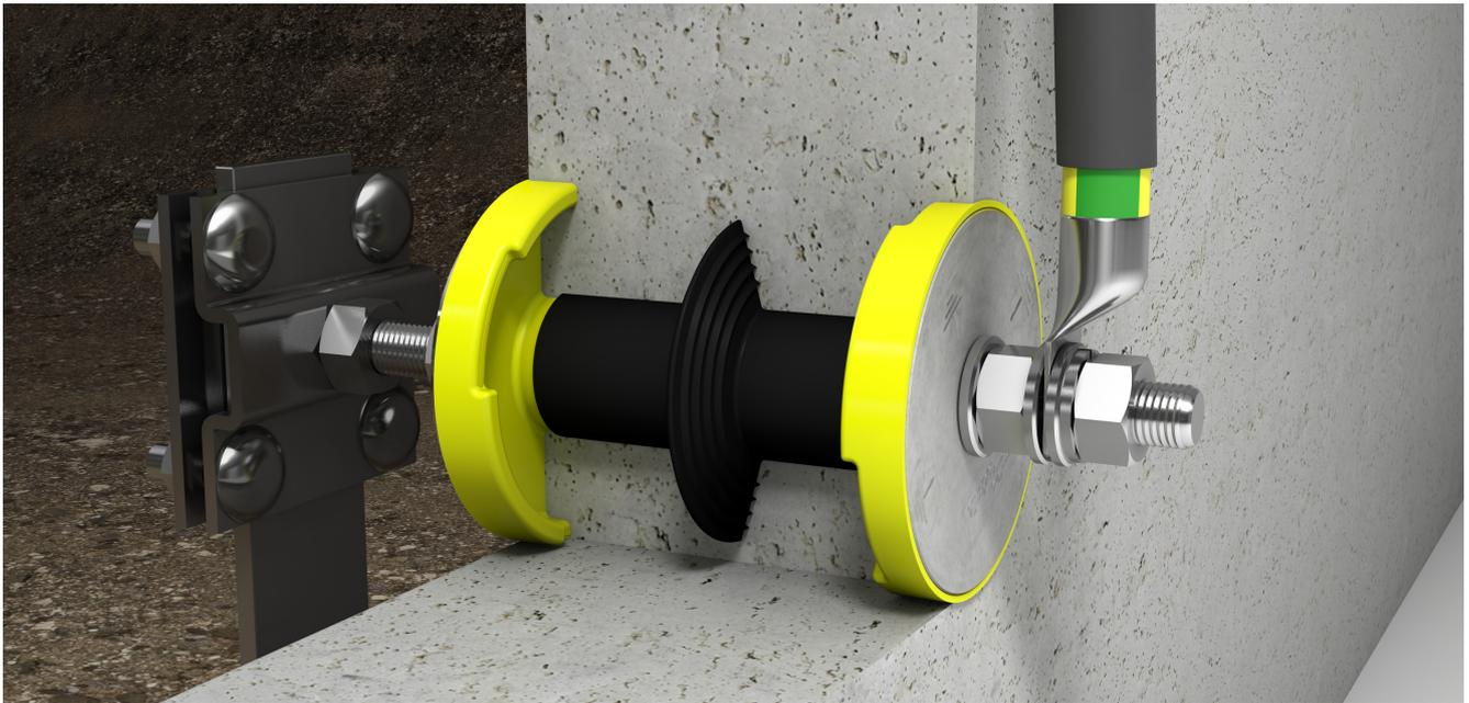
Passage de mise à la terre HEA-IS-M12: d'un côté, raccordement à barre d'acier plat par borne de fixation en croix Z-KG-M12 et de l'autre côté, raccordement d'un conducteur de terre par boulon de raccord Z-B-M12.
