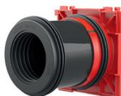
La gaine étanche simple avec manchon intégré en caoutchouc est une solution très économique et aboutie techniquement. Il assure un raccordement étanche à la pression des fourreaux lisses (Ø 110, 125 ou 160 mm). Le HSI 150-GSM reste étanche à la pression même après le raccordement du fourreaux électrique, grâce à un couvercle de fermeture préinstallé en usine. Après la pose des câbles à l'intérieur du bâtiment, l'étanchéité des câbles se fera grâce aux garnitures d'étanchéité scindées.
