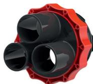
Les couvercles avec système à baïonnette sont installés dans les fourreaux étanches après la pose des câbles. Les couvercles HSI 150-D1/80, HSI 150-D3/58 et HSI 150-D7/33 sont disponibles, selon les applications, pour assurer l'étanchéité des câbles. Livrés au choix avec manchon rétractables à chaud ou à froid. Les tubulures non utilisées peuvent être fermées avec des obturateurs VS.
