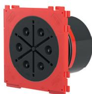
Les fourreaux à étanchéité simple sont utilisés surtout dans les milieux non accessibles pour l'étanchéité des câbles. Pour murs d'une épaisseur minimum de 70 mm. Ils sont équipés d'un couvercle de fermeture étanche à la pression et d'un couvercle de sécurité, qui sera retiré juste avant la pose des câbles. Cette double sécurité est une protection supplémentaire contre les infiltrations d'eau en cas d'ouverture accidentelle du couvercle de fermeture.
