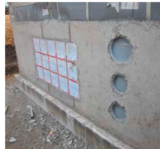
ZVR 150/300 et ZVR 200/300 scellé dans le béton à côté d'une matrice 3 x 5 de HSI 150
